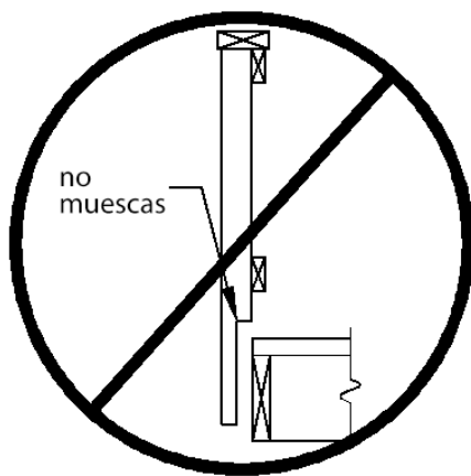
FIGURA 36: MUESCAS DE POSTE PROHIBIDAS
