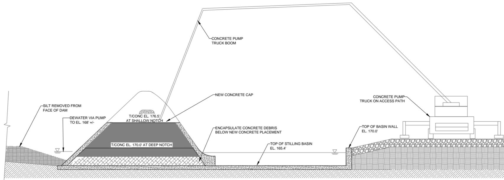
DEBRIS ENCAPSULATION - TYPICAL SPILLWAY CROSS SECTION
