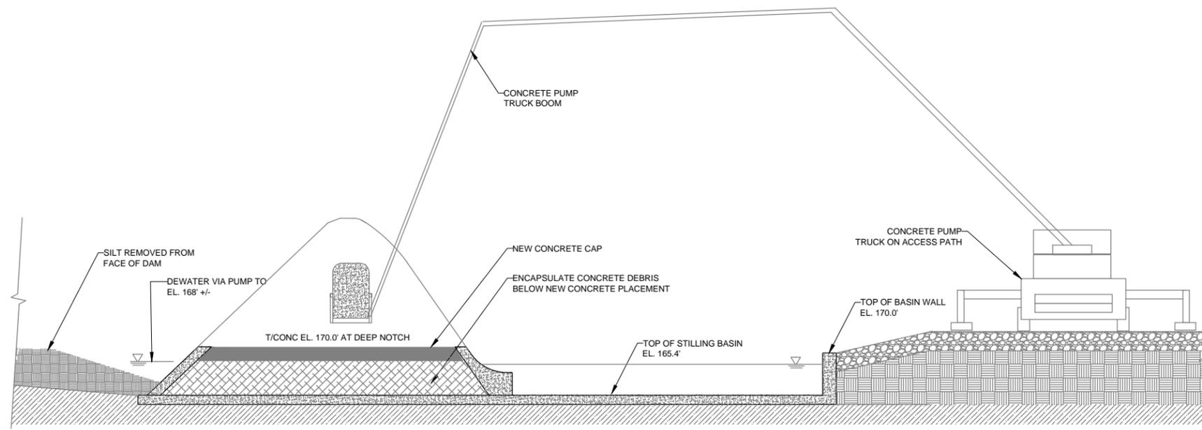
DEBRIS ENCAPSULATION - TYPICAL SPILLWAY CROSS SECTION
